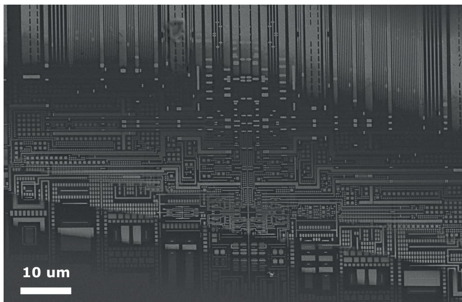
Рис. 5. Изображение верхнего слоя металлизации микросхемы RH1573. Детектор вторичных электронов
